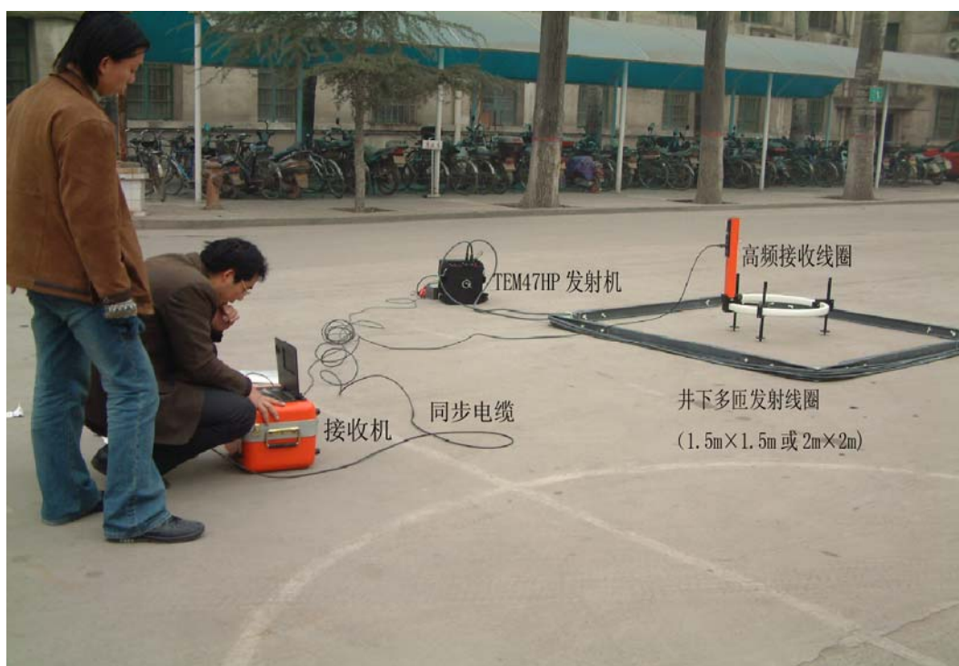
图 1 TEM47HP 井下探水系统的组成
