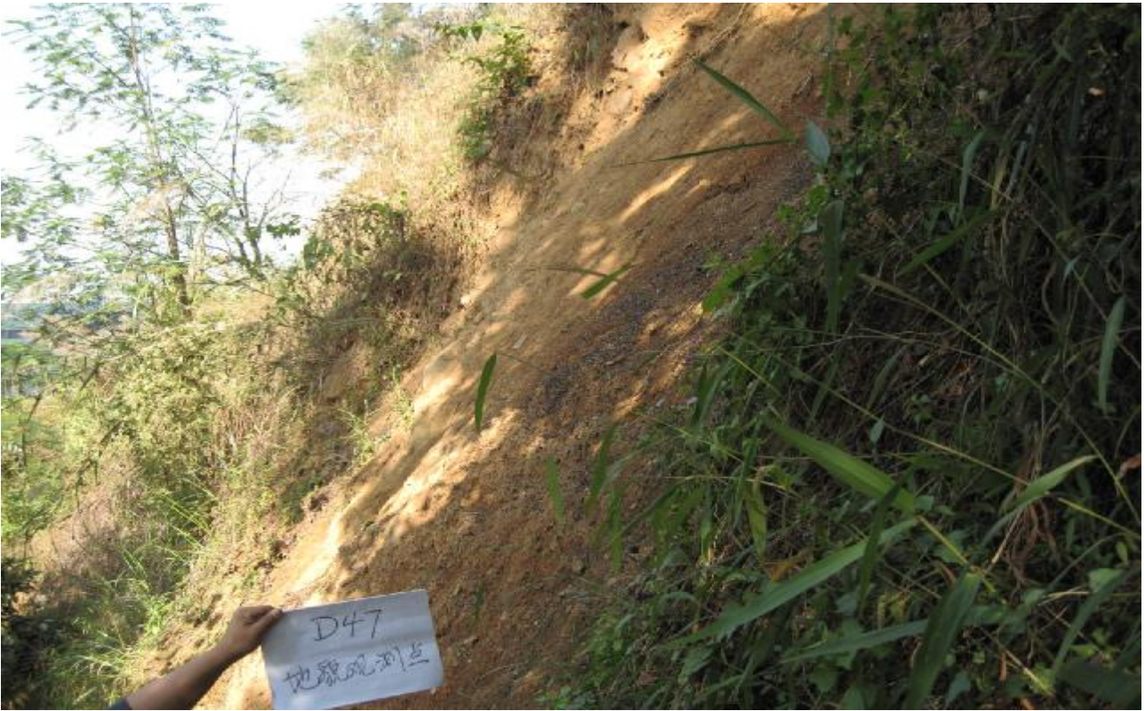
照片 3-1 滑坡中后部典型滑壁
