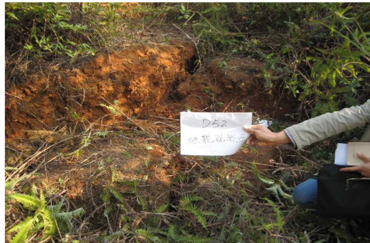
照片 3-4 滑坡中部典型裂缝
