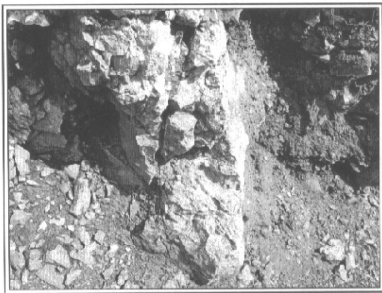
图 8-3 TCI-0 揭露出的含金石英—辉锑矿脉
