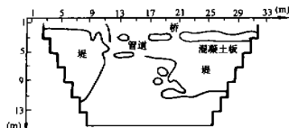
图8 北京某池塘堤内埋设物调查解释结果
