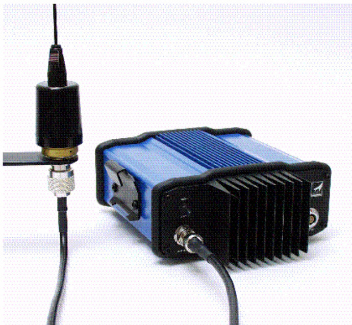
图 3.4 电缆连接到 Pacific Crest 电台和基准站电台天线
