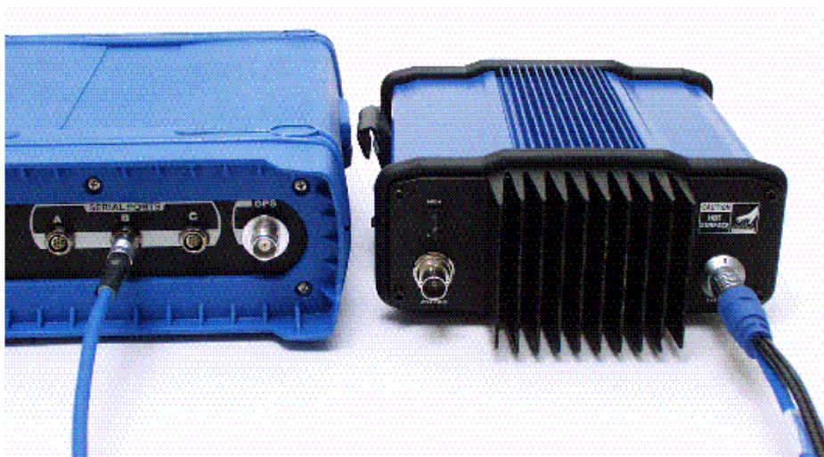
图 3.6 通信电缆连接 Z-Xtreme 接收机和 Pacific Crest 电台
