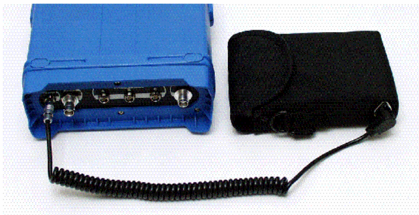
图 3.10 电源电缆连接 Z-Xtreme 和外置电池
