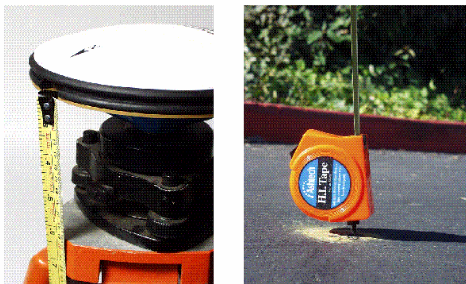
图 4.5 量测基准站 GPS 天线高
