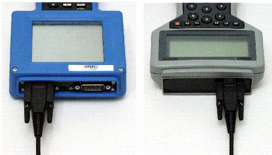
图 3.15 所有电缆连接完毕的掌上电脑
