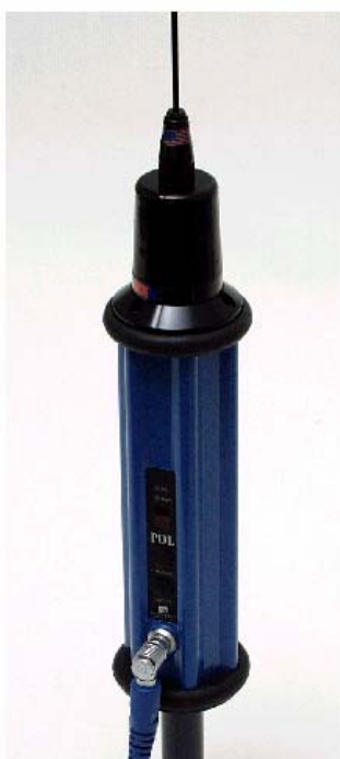
图 2.5 Pacific Crest UHF/VHF 漫游站接收机电台
