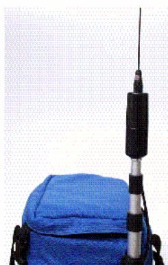
图 3.18 带有天线的 Pacific Crest PDL 流动站电台
