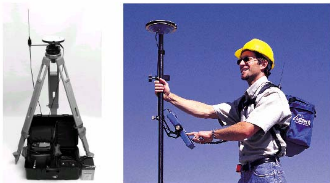
图 1.1 GPS 测量的 RTK 设置
