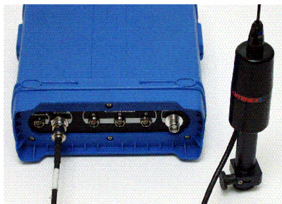
图 3.17 连接到内置电台的流动站电台天线
