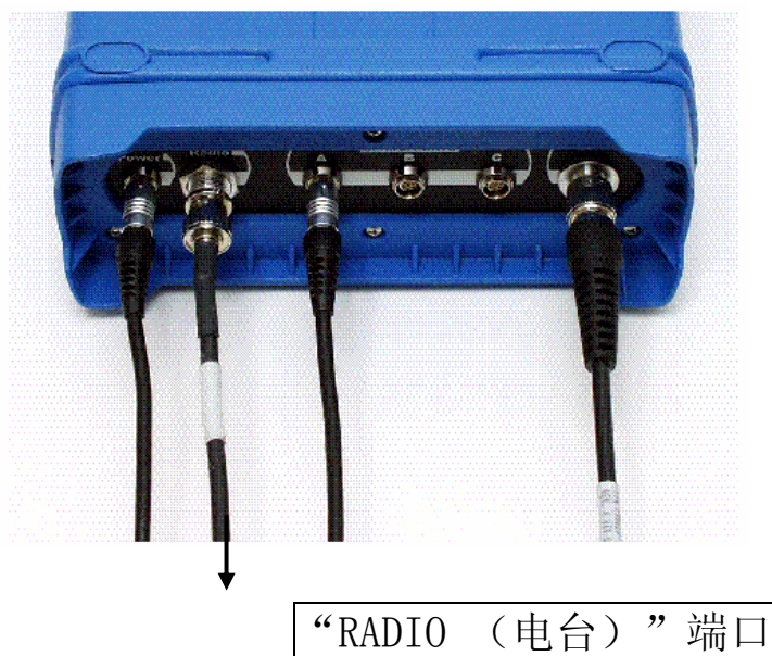
图 3.23 采用内置电台的 Z-Xtreme 流动站电缆连接
