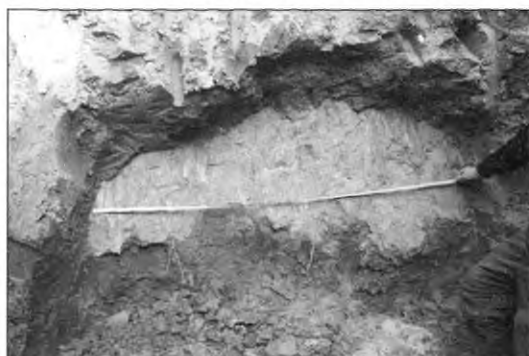
图4 探槽显示主裂缝明显擦痕
