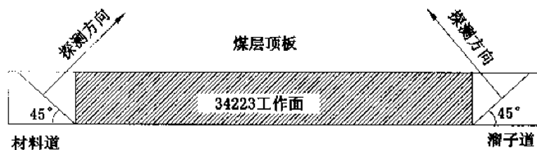
图 6-1-5 井下 TEM 测量方式示意图
