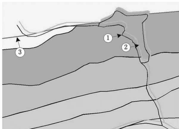
图4 水系拓扑错误 Fig.4 River topology error
