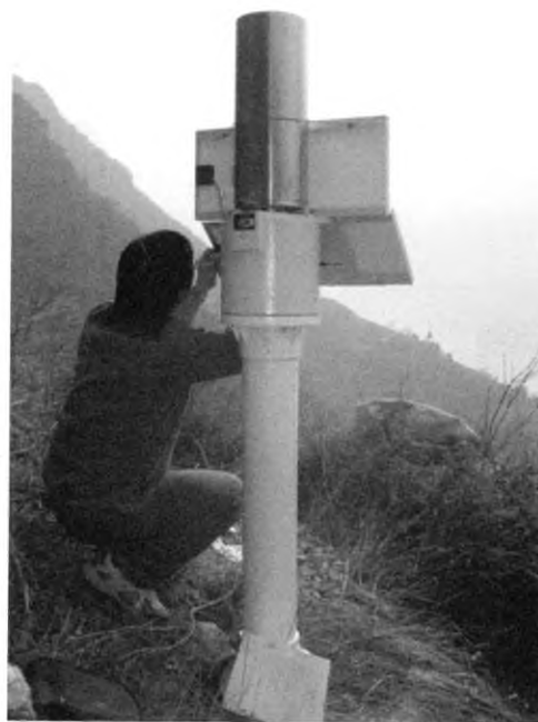
图4 现场雨量计安装
