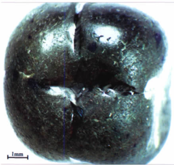
图 3 立方体金刚石晶面上的“十字架”熔蚀凹坑 Fig. 3 Macro “cross” dissolution pattern observed on (100) surface of a diamond crystal
