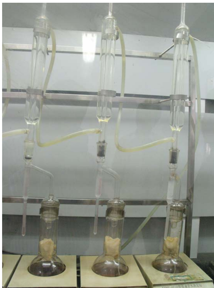
图 1 蒸馏抽提法测量油水饱和度的装置
