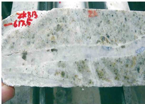
图 2 甲玛矿区 ZK813 钻孔内斑岩中的含钼石英脉
