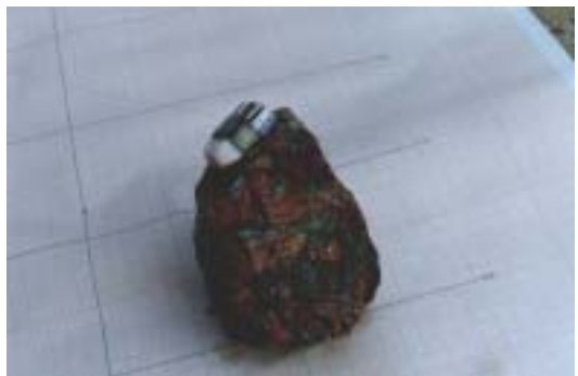
图版 -3 八中段由黄铁矿、黄铜矿、方铅矿、钾长石、银金矿所组成的矿石
