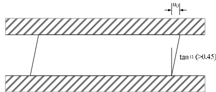
5.5.2-2 板式橡胶支座剪切超限
