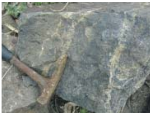
照片 -6 石榴石磁铁矿金矿石 (深灰色为磁铁矿, 浅黄色为钙铁石榴石)
