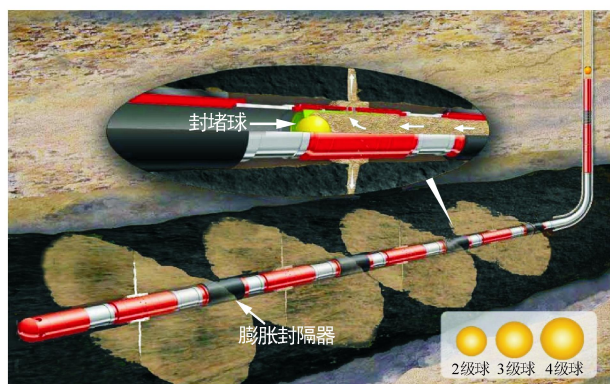
图1 滑套完井多级压裂作业图
