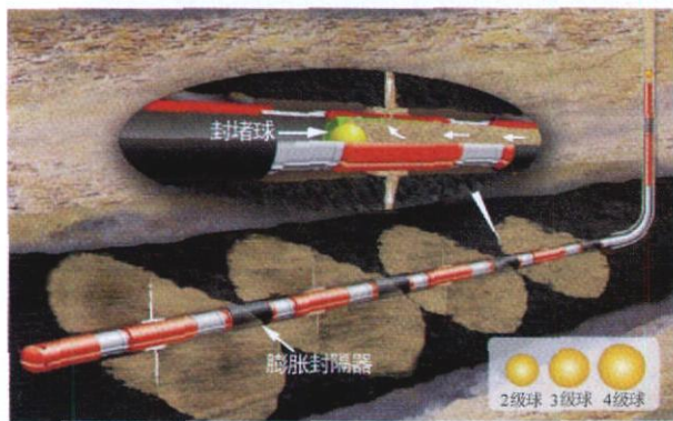
图 1 滑套完井多级压裂作业图
