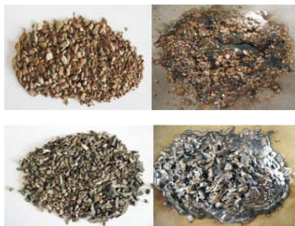
图 4 滨海 6 井泥岩(上)和滨深 22 井泥页岩(下)在快速钻井液中 120 ℃、16 h 热滚前后对比图
