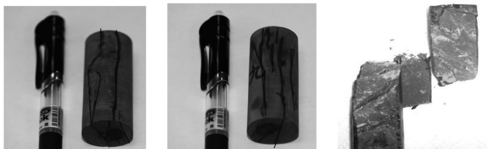
图 8 9 号岩心浸泡 19d 后的岩心裂缝分布及破坏模式
