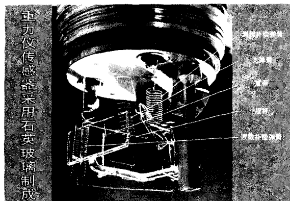
图3 重力仪的石英弹簧系统 (最细的石英丝直径仅有数微米)
