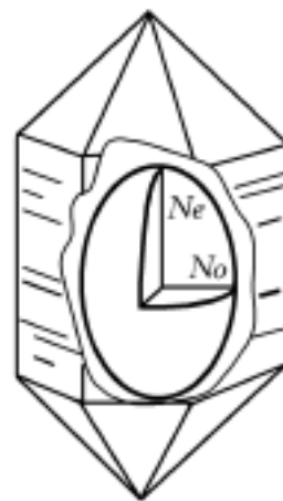
图 1-1 水晶晶体折射率与方向的关系图——光率体
