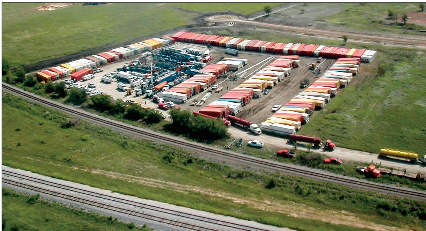
▲ Barnett 页岩大型水力压裂作业现场。在该单级增产措施中,将100多个装满水的压裂罐运往井场并放置在井场周围。泵送装置、管汇和监测设备等则被放置在井场中心附近的井口周围。由于采用了新的完井方法,现在所需的材料和设备少了很多。现在,作业者将井筒分成一些小层段,并对其实施多级增产处理。这一新方法改善了油气井动态,降低了完井成本。
