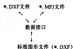
图1 *.DXF与*.MPJ文件间的标准图形文件的数据格式是公开的,以ASCII形式存放,实现接口部分用VC++的一个已知格式ASCII文件的读写进行操作。如:一条直线,仅需要两个端点坐标;对圆,仅需要它的圆心坐标和半径;对于弧,仅需要圆心坐标、半径、起始角和终止角。实现对*.MPJ文件信 Fig.1 *.DXF and *.MPJ file data conversion
