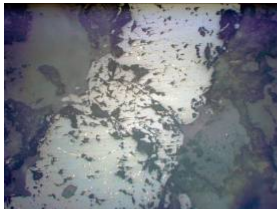
照 3.16 黄铜矿闪锌矿固溶体分体结构(20×-)
