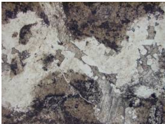
照 3.9 绿泥-绢云母化黑云角闪石英闪长岩 照 3.10 花岗细晶岩 (中-轻度风化) (4×-) (2×+)
