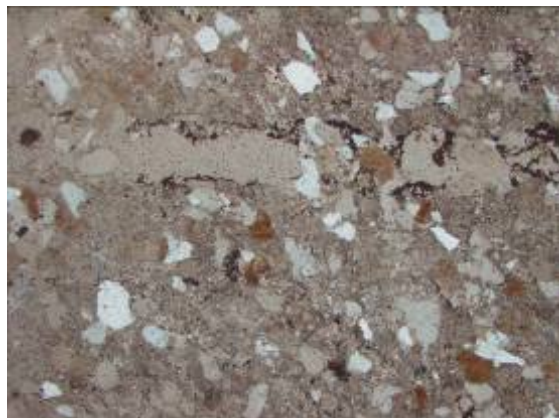
照 3.7 绿泥石绢云母化石英闪长玢岩 (4×+) 照 3.8 绿泥绿帘石化闪长玢岩 (4×+)
