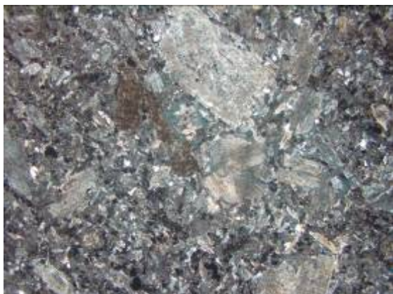
照 3.5 碳酸盐绿泥绢云母化辉绿玢岩 (4×+) 照 3.6 黑云母辉石辉绿玢岩 (4×+)
