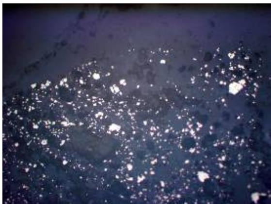
照 3.19 浸染状构造 (10×-)
