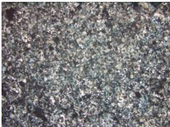
照 3.9 绿泥-绢云母化黑云角闪石英闪长岩 照 3.10 花岗细晶岩 (中-轻度风化) (4×-) (2×+)
