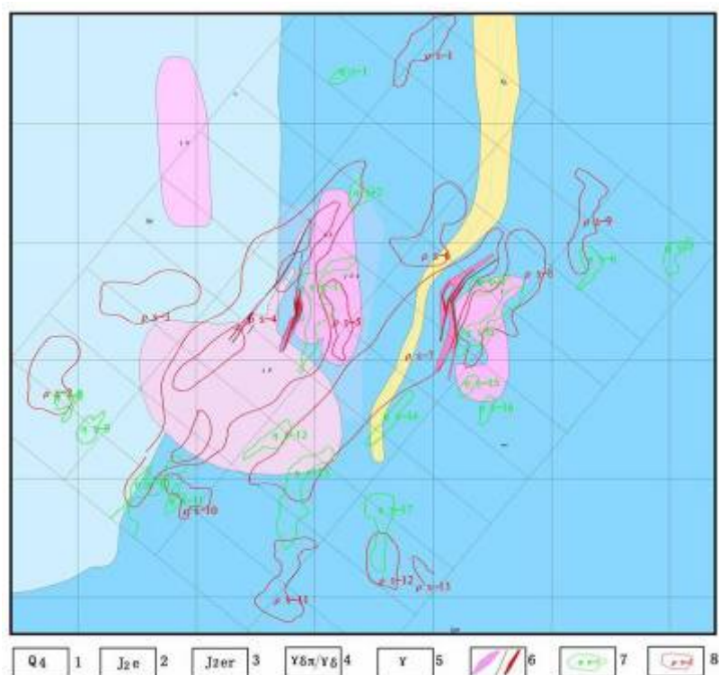
图 6.1 宝兴沟矿区激电中梯测量综合异常图
