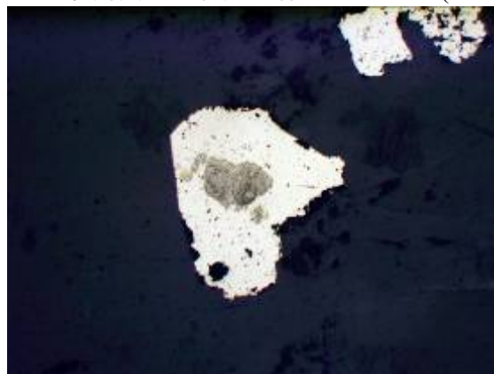
照 3.18 交代结构(斑铜矿、黄铜矿交代 黄铁矿)(10×-)
