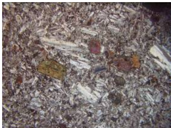
照 3.5 碳酸盐绿泥绢云母化辉绿玢岩 (4×+) 照 3.6 黑云母辉石辉绿玢岩 (4×+)
