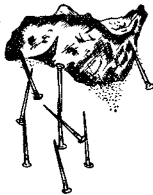
图 25 磁铁矿吸引小铁钉的现象
