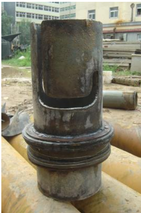
PVC-U塑料管井破碎爆裂事故处理中采用的补管上端 密封装置和挂口
