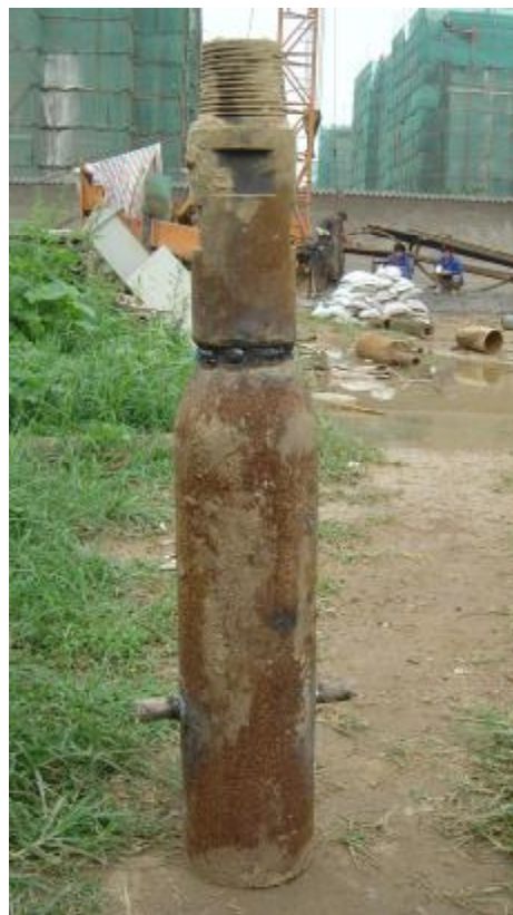
PVC-U塑料管井破碎爆裂事故处理中采用的补管上端 密封装置和挂口
