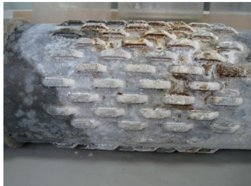
金属桥式过滤管腐蚀结垢情况（30天）
