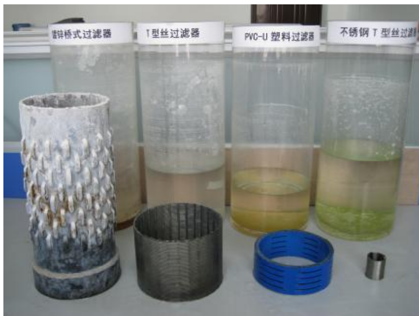
不同过滤管腐蚀结垢试验
