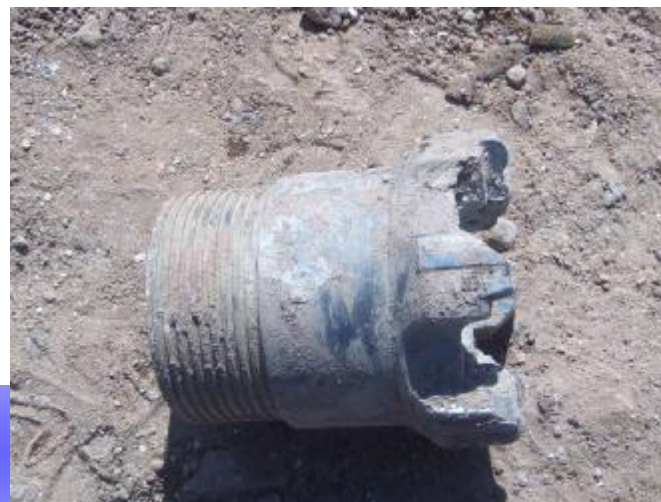
图 17 复合片金刚石钻头
