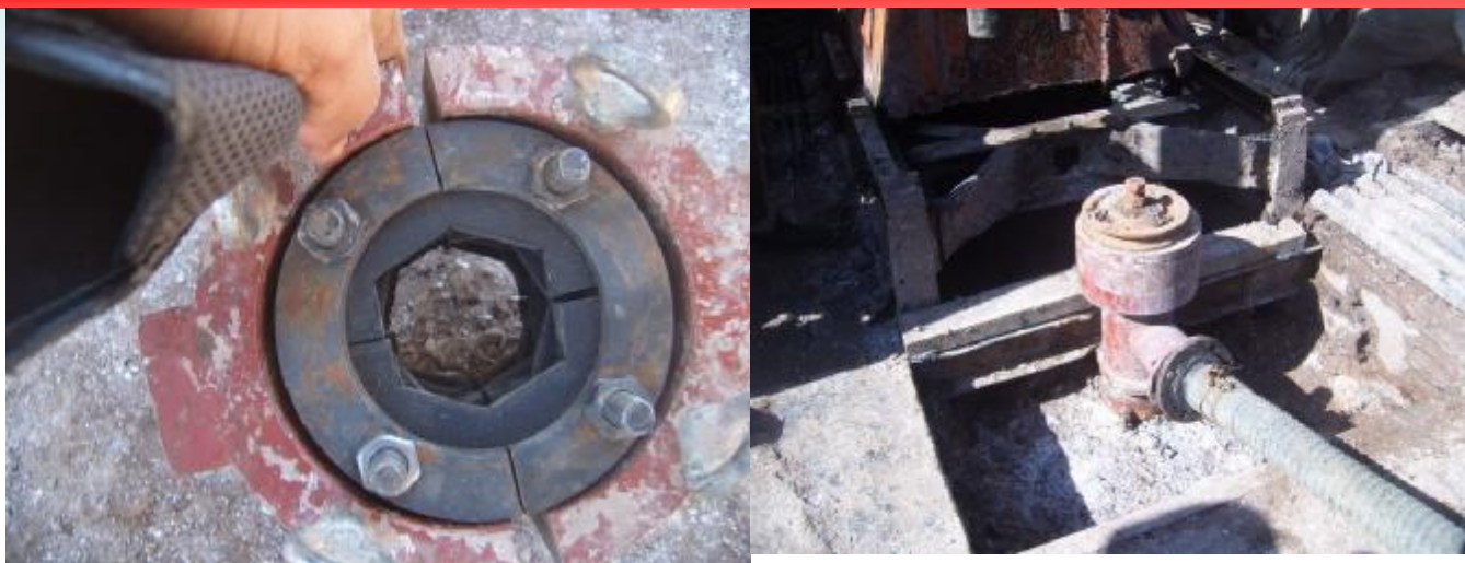
图 18 孔口密封装置
