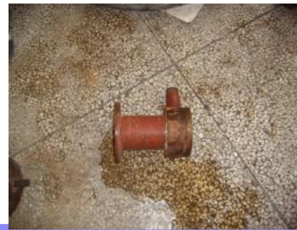
图 4 消泡器的入口接头
