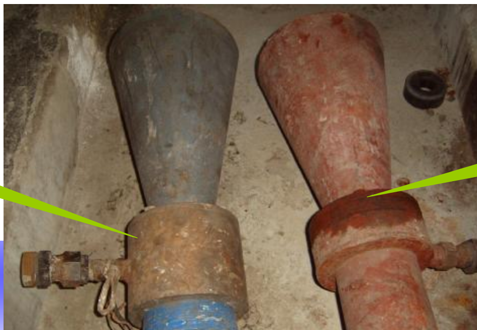
图 31 65型缝隙式消泡器结构原理图
