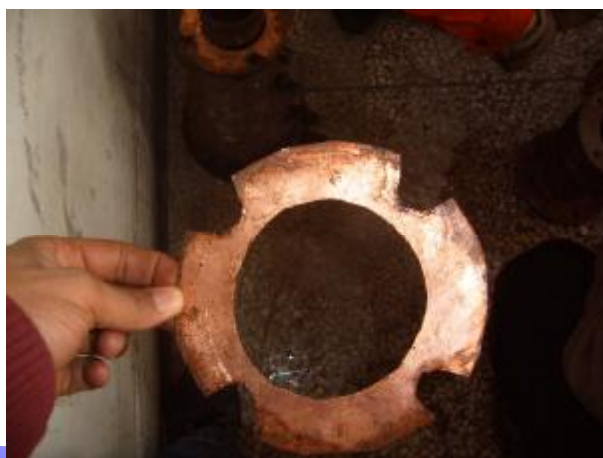
图 3 消泡器的垫片
