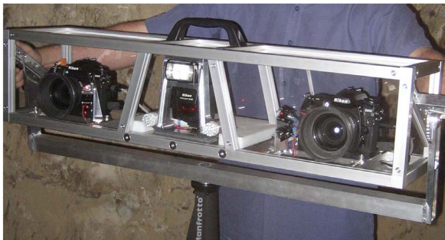
地下工程摄影测量硬件系统图
