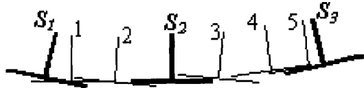
图8 利用控制片 S_1, S_2, S_3 进行空中三角测量
