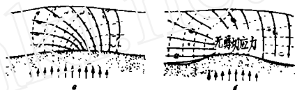
图14 在软承压作用下，形成横向褶曲的背斜时主要切应力的分布
