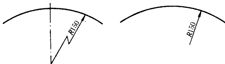
图 10.4.3 大圆弧半径的标注方法
