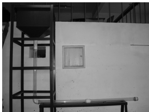
图 1 实验室 L 型管道自流输送试验装置
