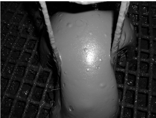
图 2 充填料浆进入钻孔
