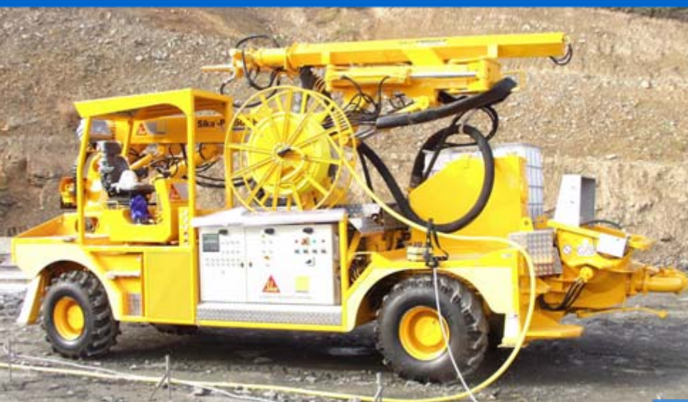
瑞士Sika—PM500P 湿拌混凝土喷射机
