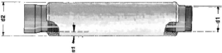
图 41 贴砾滤水管结构
