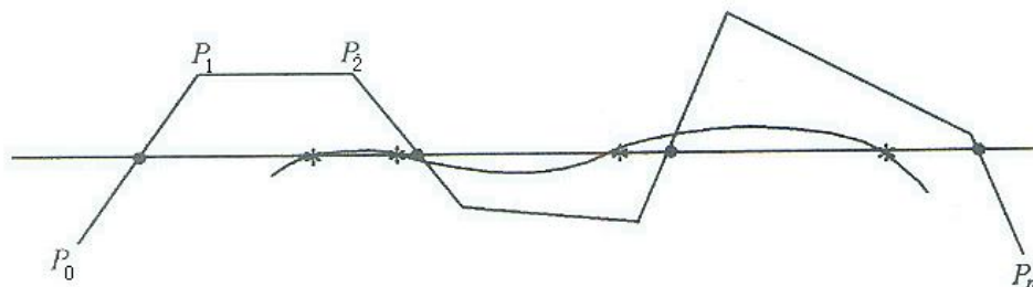
图 6-13 B 样条曲线的变差缩减性
