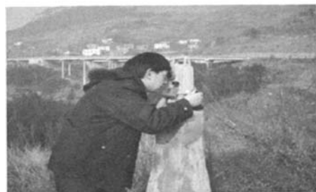
图 5 现场表面位移监测
