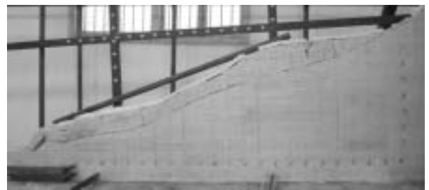
图 13 145 m 滑坡模型破坏影像
