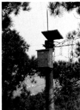
图2 引张线数据采集设备
