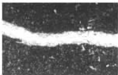
照片 3—28 硅化千枚岩石英 呈细脉分布于千枚岩 中(+), 10×
