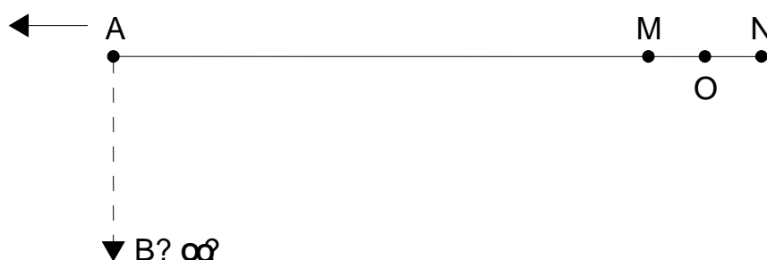
图 1 三极测深法工作布置图
