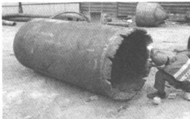
图 3 硬质合金套筒取心钻头
