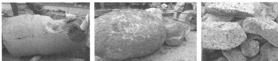
图 8 纠偏施工取出的部分岩心
