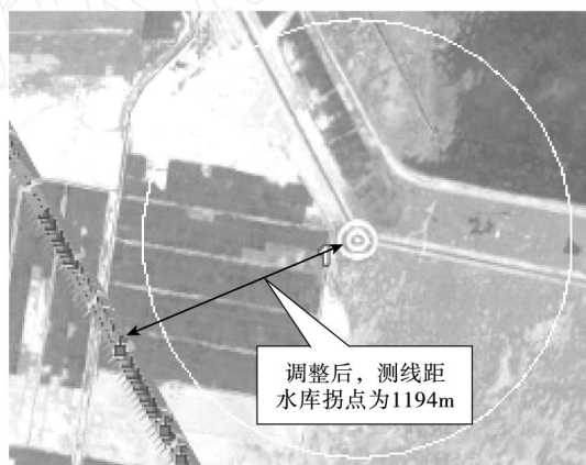
图6 AN06-345测线调整前和调整后的对比效果图
