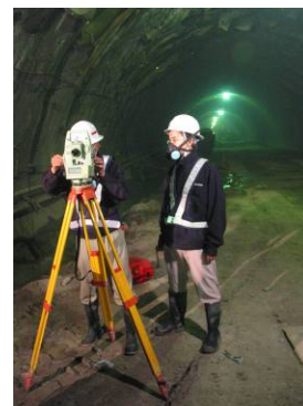
圖5.3.6 3D光學量測系統監測作業
