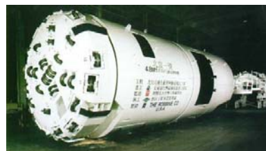
圖5.1.4 雪山隧道導坑工程之TBM
