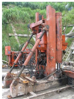
圖5.1.6 雪山隧道一號豎井昇井鑽機與承載座
