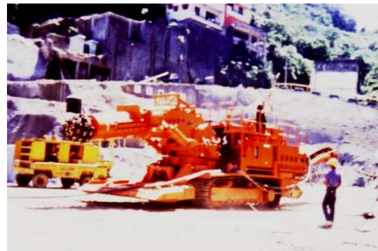
圖5.2.4 新店隧道群所使用之旋臂式掘削機
