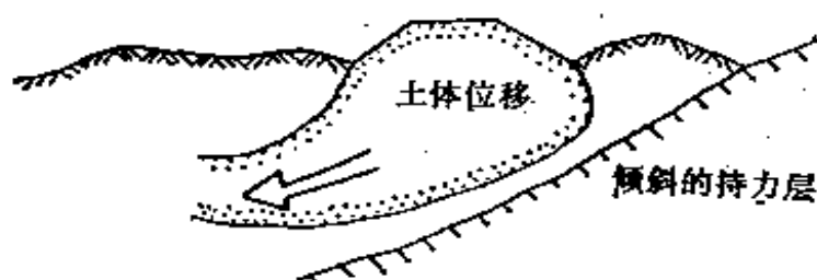
图 4-30 在倾斜的持力下卧层上用置换土方法筑堤的困难
