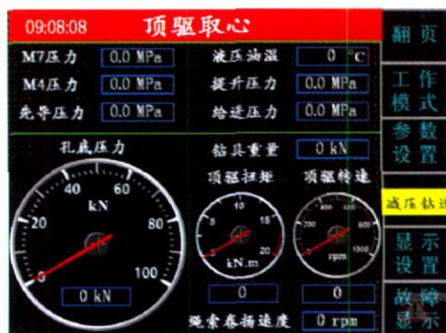
图3 KZ3000型钻机上配备的钻参仪
