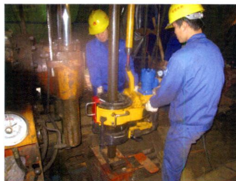
图 8 SQ114/8 型液压钳在江西九江武山施工现场
