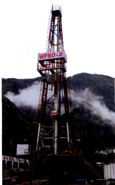
图1 KZ3000型科钻深部取心钻机
