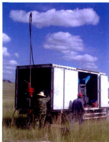
TGQ-75型车载全液压取样钻机
