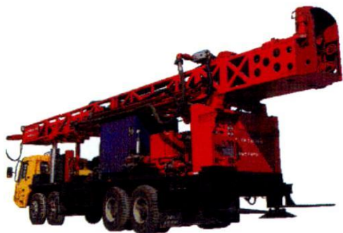
SDC-1000型全液压车装动力头水井钻机
