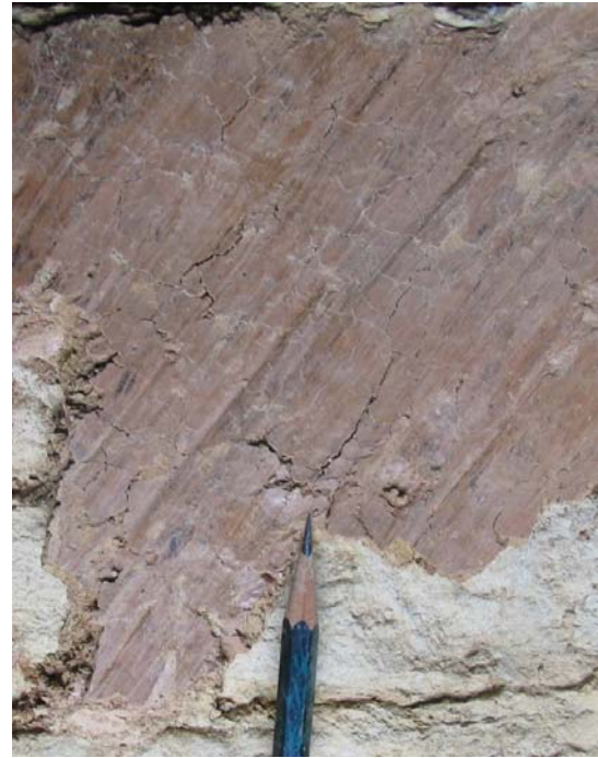
照片 1-4 箭穿洞危岩体揭露显示的变形擦痕
