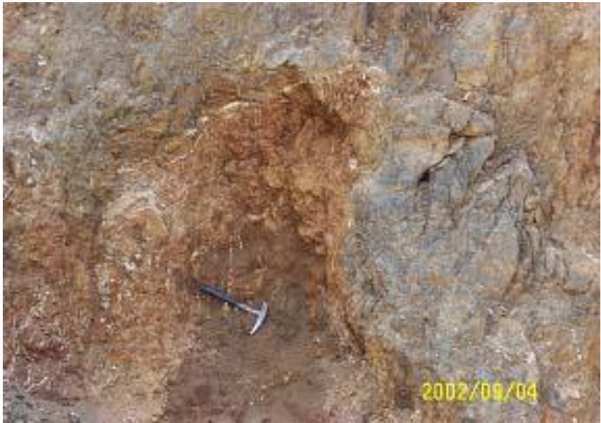
照片 3-1 破碎带中的糜棱面理发育 (BT1201)
