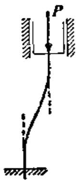
图 1.9 例 1 中有缺陷的柱
