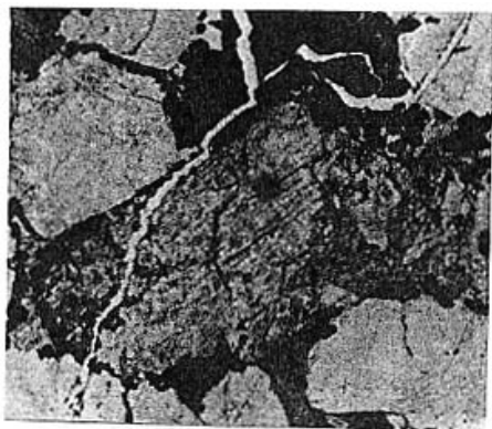
图 A9. 粗粒岩屑石英杂砂岩中的长石颗粒 KWBH08230102 (单) \times 31 P 1 山西太原 为斜长石, 板状, 无色透明, 具解理, 表面已部分 风化成交解石。
